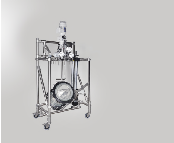
Schritt 5: Einstellung Kippwinkel in arretierter Position
